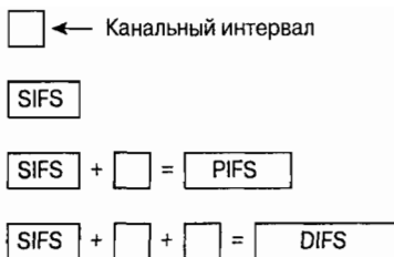
Рис. 2.16. Отношения между SIFS, PIFS, DIFS и канальным интервалом
