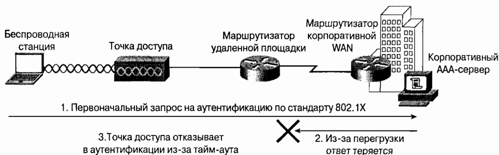
Рис. 8.7. Влияние перегрузки канала WAN на процесс аутентификации по стандарту 802.1x на удаленных площадках
